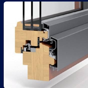
PaXoptima78, U_w bis 0,85 W/(m 2 K)**
