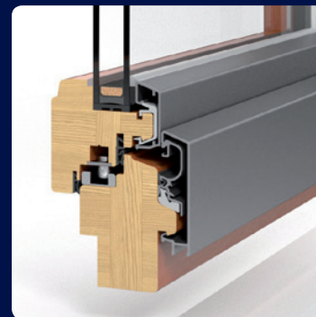
PaXoptima68, U_w bis 1,3 W/(m 2 K)*
